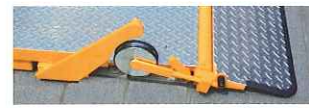
▲自動開閉 (ハルタ式自動リンク) 後ろフラッパー Auto Rear Rollstop
