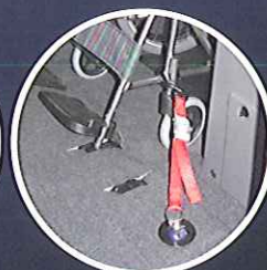
車いす前側の固定状態
